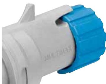
L'impugnatura delle spine Multimax integra un sistema di blocco automatico del pressacavo che protegge da possibili svitamenti accidentali. Il pressacavo può essere facilmente sbloccato sollevando il braccetto di tenuta
