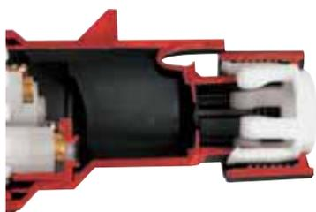
Gli speciali ganci a tenuta inversa sono un'efficace sistema di protezione contro gli strappi in quanto oppongono allo sforzo di trazione una forza uguale e contraria sulla parte isolante del cavo.
